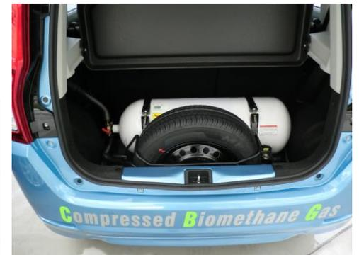
ワゴンRのトランクに搭載のCNGタンク
